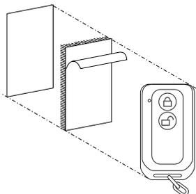
El activador inalámbrico se puede fijar en la pared usando la cinta incluida.
