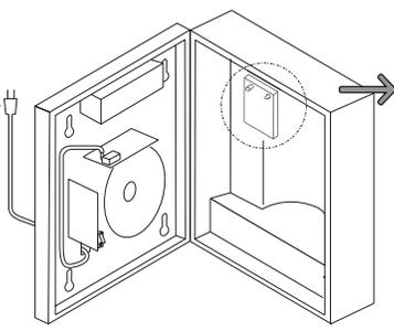
2. Presionar el botón del módulo RF durante tres segundos (el LED encenderá mientras se mantiene presionado).
