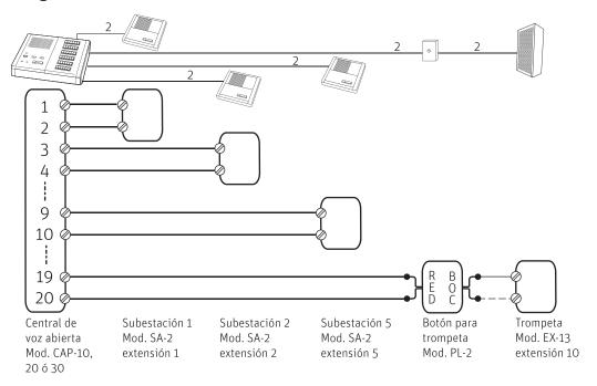
Nota: La central CAP-10 tiene una roseta, la CAP-20 tiene dos rosetas y la CAP-30 tiene tres rosetas, cada roseta conecta con 10 subestaciones o trompetas a dos hilos cada una.
